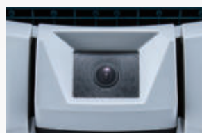
La caméra réalise des images du plafond pour faciliter la navigation.
