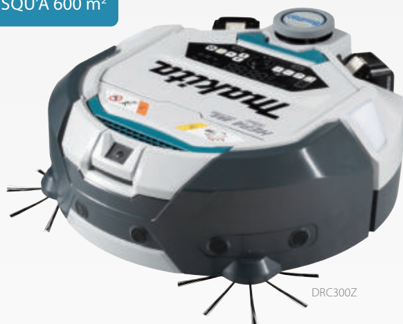
La caméra réalise des images du plafond pour faciliter la navigation.
