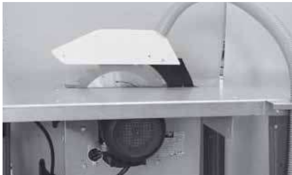
Buse d'extraction 2 ø 38mm
